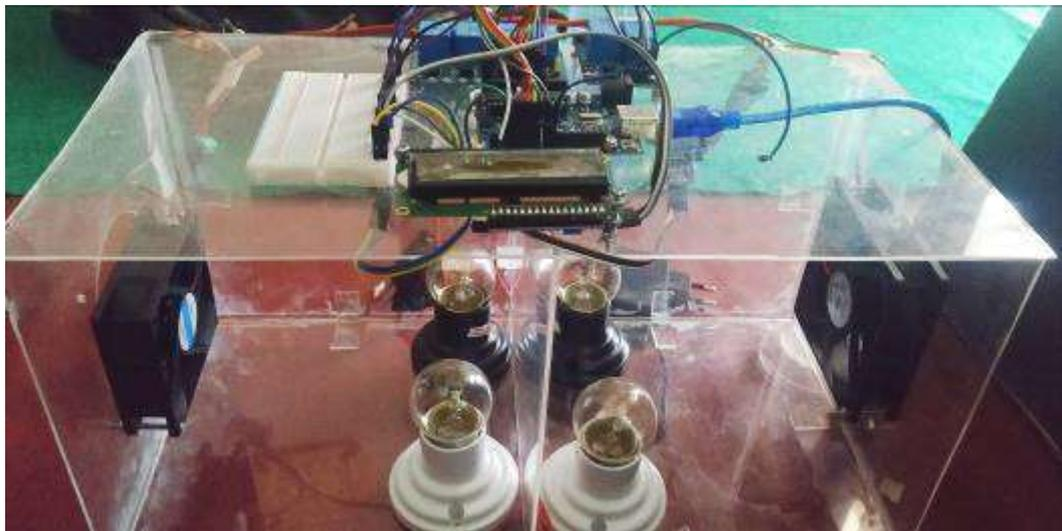
**Gambar 2. Prototipe Penetas Telur Ayam**
