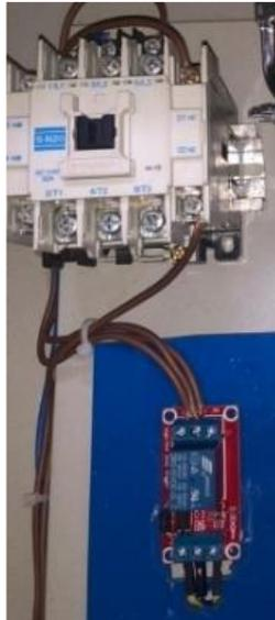
**Gambar 4 NO Relay yang digabungkan ke Kontaktor 3 fasa**
