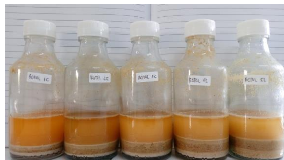
Gambar 2. Sampel adsorben setelah adsorpsi dengan variasi rasio kulit telur ayam dengan sekam padi a) 3:1, b) 2:1, c) 1:1, d) 1:2, e) 1:3.
