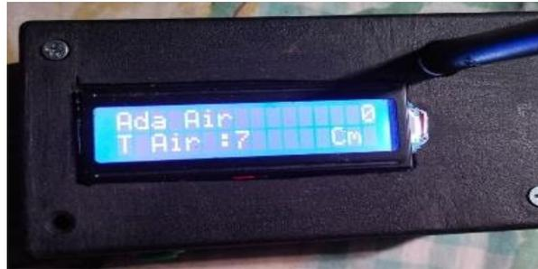
**Gambar 3.1 Hasil pengukuran tinggi air menggunakan LCD**
