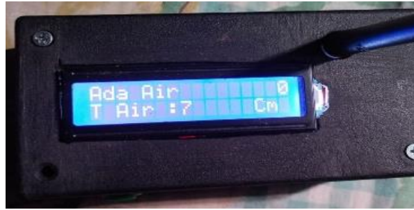
Gambar 3.1 Hasil pengukuran tinggi air menggunakan LCD
