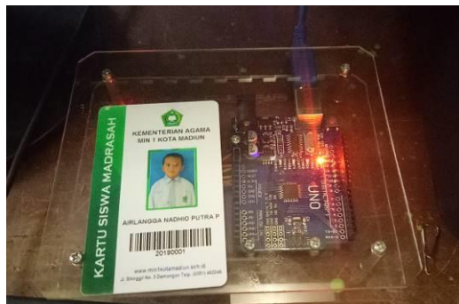
Gambar 15. Pemasangan Alat RFID reader
