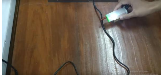
Gambar 9. Buzzer dan LED menyala saat ada arus
