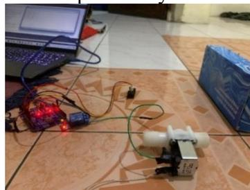
**Gambar 9. Pengujian Relay dan Solenoid Valve**
