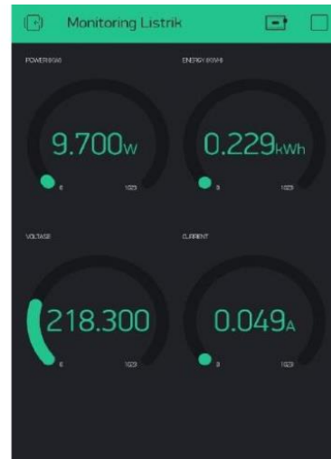
(b) Setelah Terjadi Kebocoran Arus
