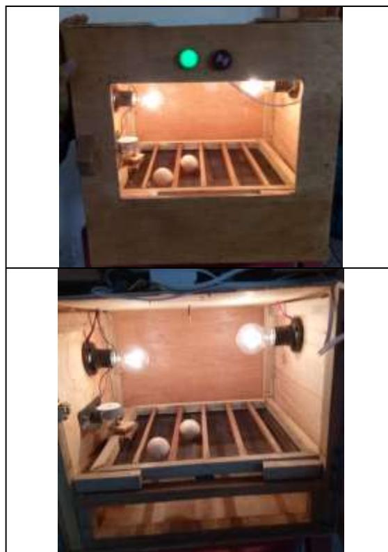
**Gambar 3. Alat Penetas Telur Sederhana Bongkar Pasar untuk Peragaan**
