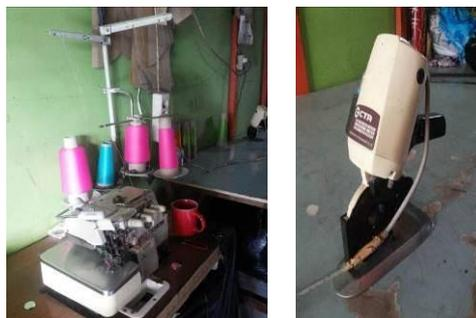
Gambar. 3 Alat Pemotong Kain
