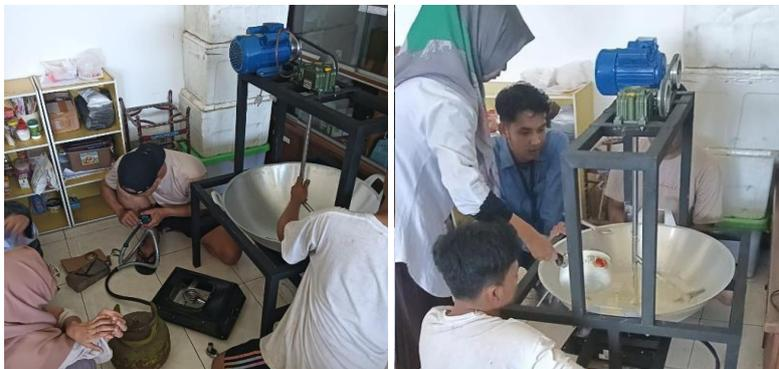
**Gambar 2. Pembuatan dan pengujian alat molen pengaduk adonan dodol rumput laut.**
