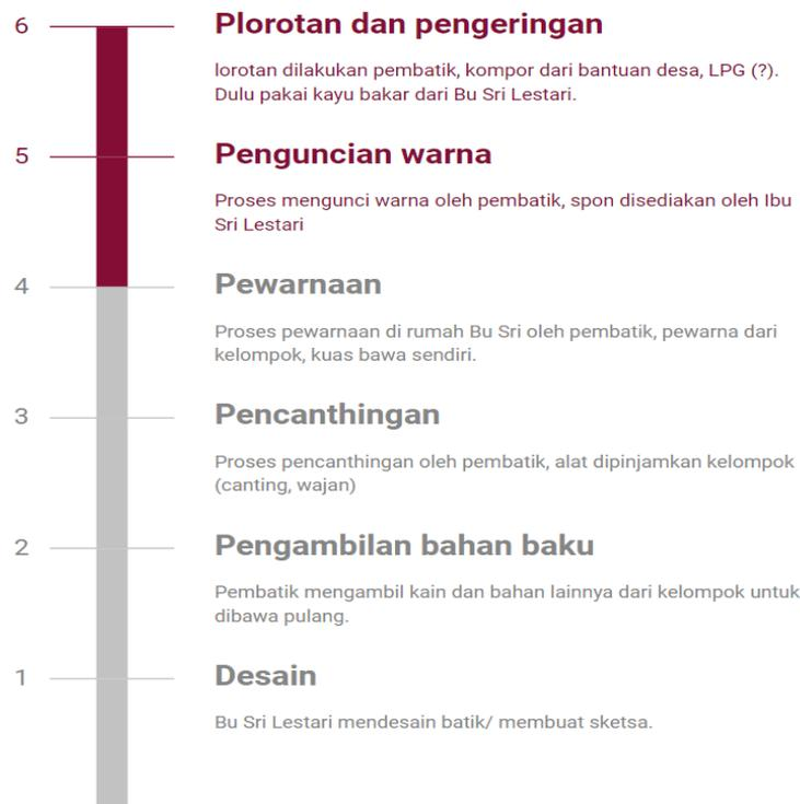
**Gambar 2.** Bagan urutan produksi, alat, bahan, dan pelaku untuk produksi selembur kain batik.
